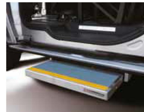
Marchepied latéral coordonné à l'ouverture de la porte Facilite l'accès au véhicule
